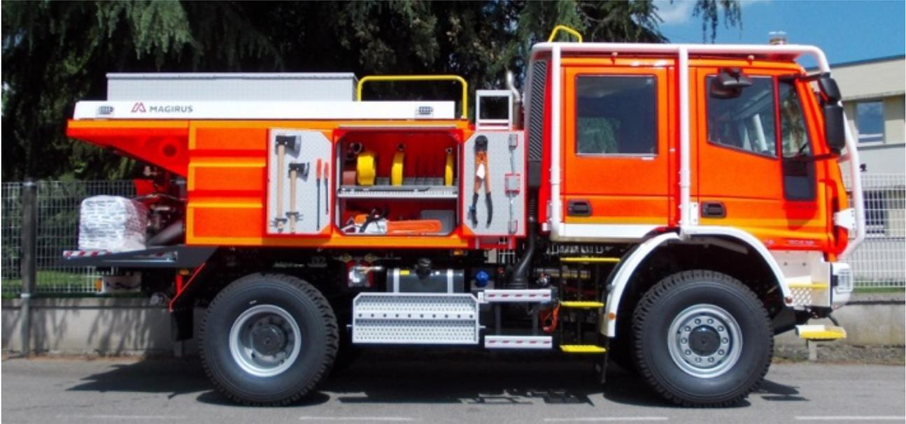
8.1 Estructura Principal: Carrocería completamente en acero AISI 316L, inoxidable tipo monobloc para mayor resistencia:
