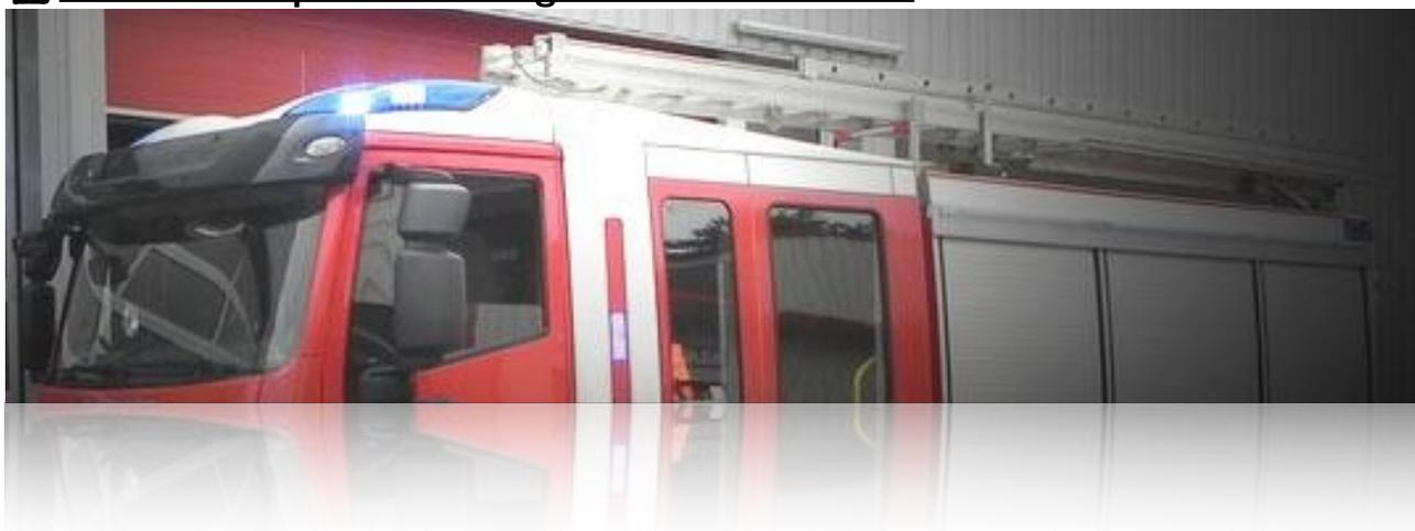
Baliza integrada sobre el techo de la unidad, de esta manera se obtiene una unidad mas aerodinámica y moderna. Las balizas son LED y están completamente integradas al sistema CanBUS de la unidad.
