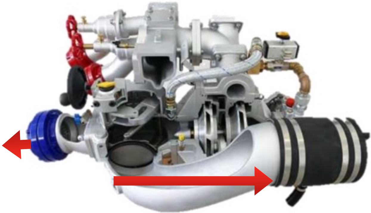
Flujo del exceso de presión.
