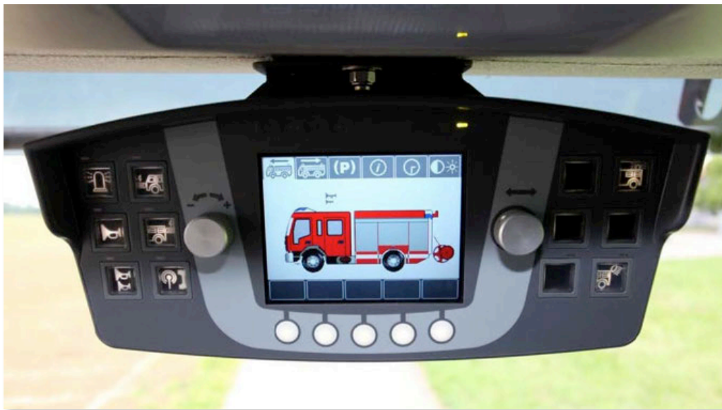
Control HMI en cabina
