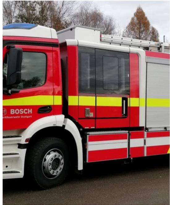
7.1 Cabina simple abatible hacia adelante que permite el acceso al motor, caja de cambios y otros elementos de manera cómoda y segura.
