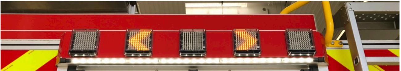
13.3 Luces de escena MAGIRUS con banda LED o foco, bandas por cada lado y en la parte trasera de manera de generar una iluminación perimetral optima y sin encandilar a los operadores. Cumple con norma para bomberos. Capacidad de 1000 lúmenes cada tramo.
