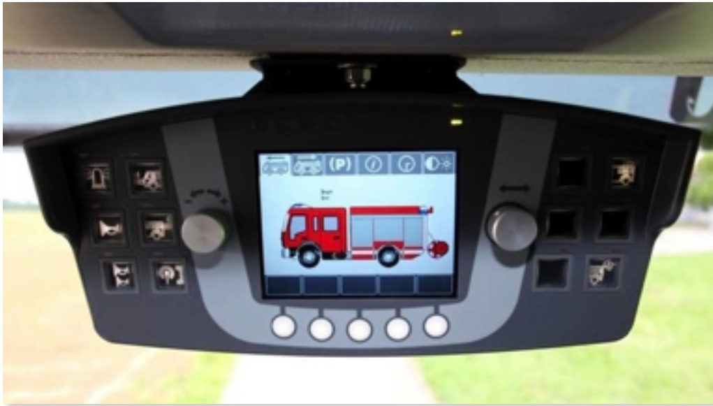
Control HMI en cabina
