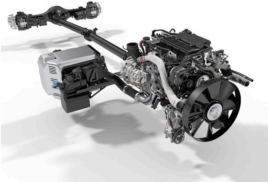
El sistema de refrigeración es capaz de permitir su funcionamiento en situación estacionaria con la bomba hidráulica funcionando en condiciones nominales de presión y caudal a una temperatura ambiente no inferior a 40°. IVECO MAGIRUS no considera necesario contar con sistema de refrigeración auxiliar.
