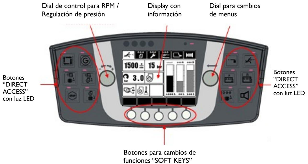
En conjunto con una serie de módulos Spliter el control HMI representa al sistema de vanguardia CAN-BUS de la súper estructura, que permite al usuario ser mas eficiente en la operación y procesamiento de información durante una intervención.
