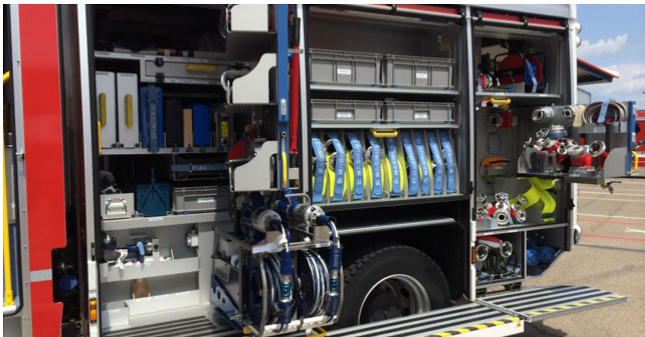
8.1 Estructura Principal: Carrocería completamente en perfiles de aluminio reforzado ensamblado por piezas de unión, mantenida por visaje, y paneles de aluminio pegados:
