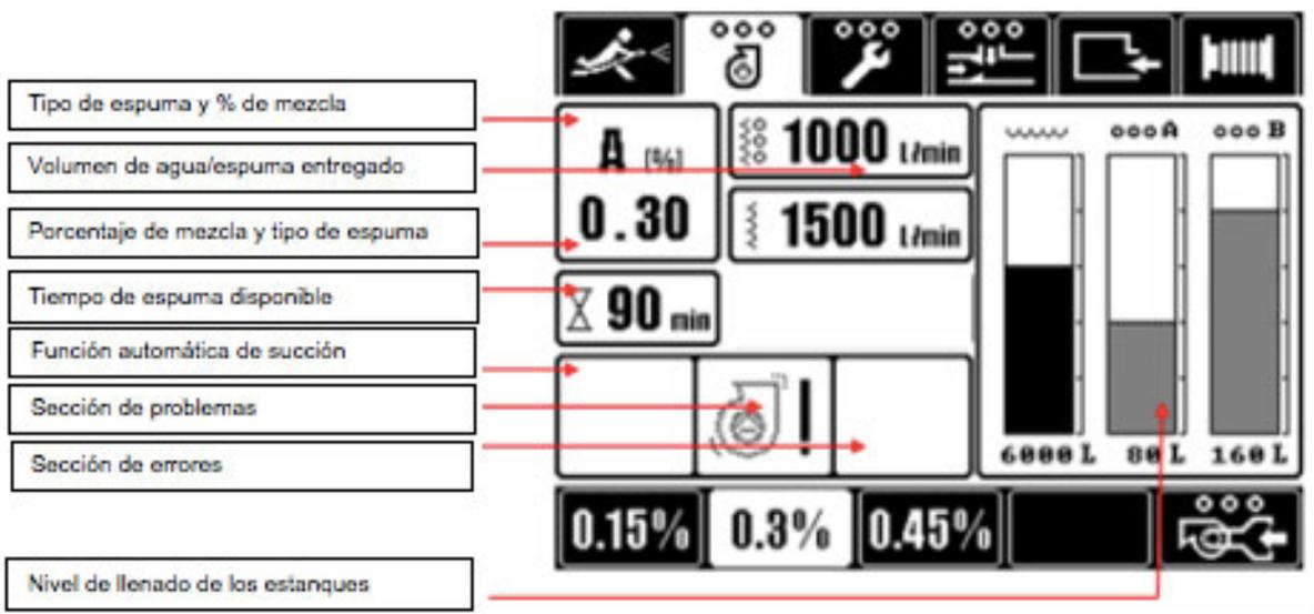
Figuras muestran la información del HMI, para el menú agua y espuma existen diversas opciones disponibles dependiendo del tipo de premezclador que se utilice.
