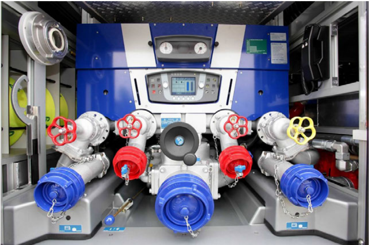
Panel de control de la bomba con HMI y manómetros.
