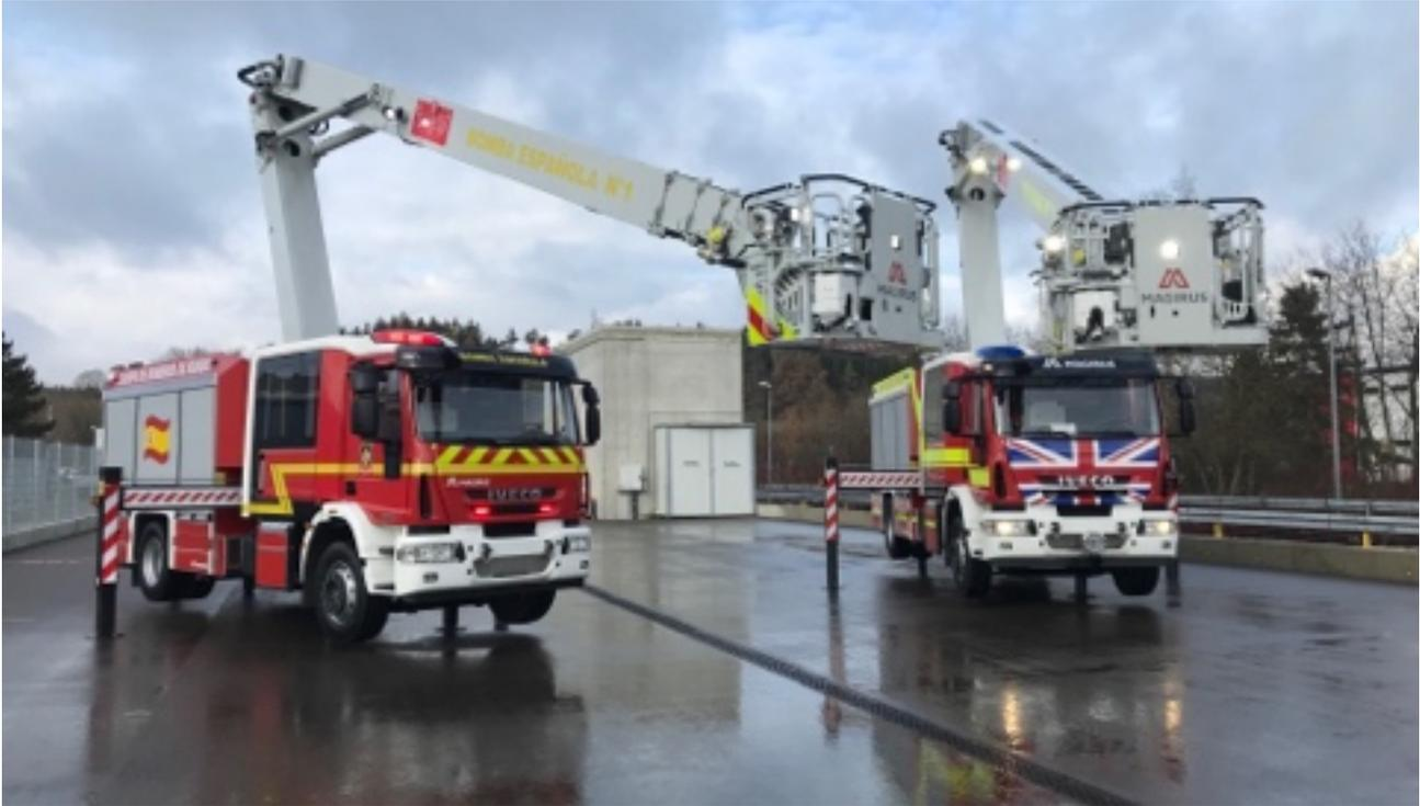
Boom de dos piezas con boom elevado por un cilindro hidráulico y tres piezas telescópicas. El boom superior es controlados por dos cilindros hidráulicos ambos fabricados de aluminio.
