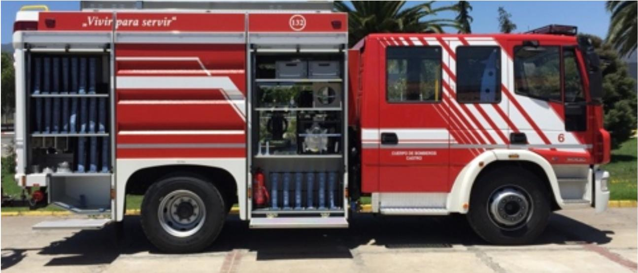
8.1 Estructura Principal: Carrocería completamente en perfiles de aluminio extruido y anodizado ensamblado por piezas de unión, mantenida por visaje, y paneles de aluminio pegados:
