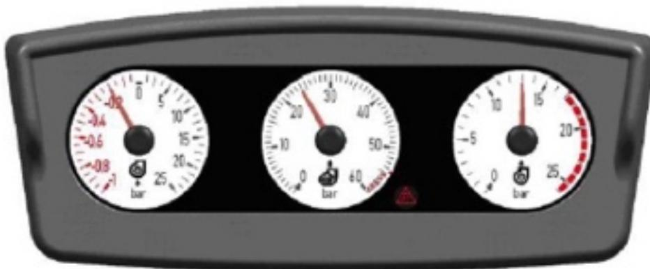
El panel de control de la bomba posee los manómetros digitales. para indicar succión, alta presión y baja presión.
