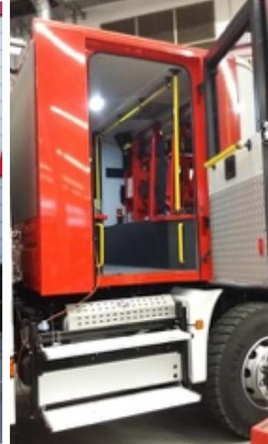
7.1 Doble cabina con mecanismo hidráulico que permite la basculación manual de la cabina completa. Posee sistema de seguridad que impide la caída accidental de la cabina.
