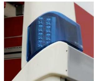
13.7 Dos luces estroboscópicas LED MAGIRUS en la cara delantera de la unidad en la toma de aire del chasis de manera de que sea fácilmente visible por vehículos mas pequeños.
