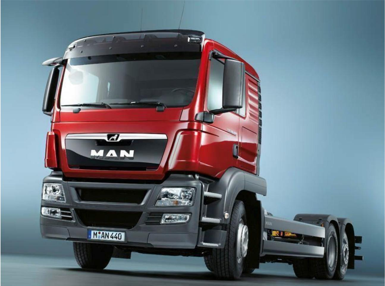
7.1 Cabina simple abatible hacia adelante que permite el acceso al motor, caja de cambios y otros elementos de manera cómoda y segura.
