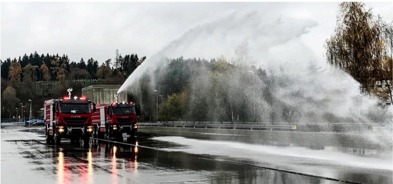
18.4 Piton monitor frontal con desalojo de 2000 lpm conectado directo a la bomba. Posee control electrónico de movimientos desde la cabina y sistema pump & roll.
