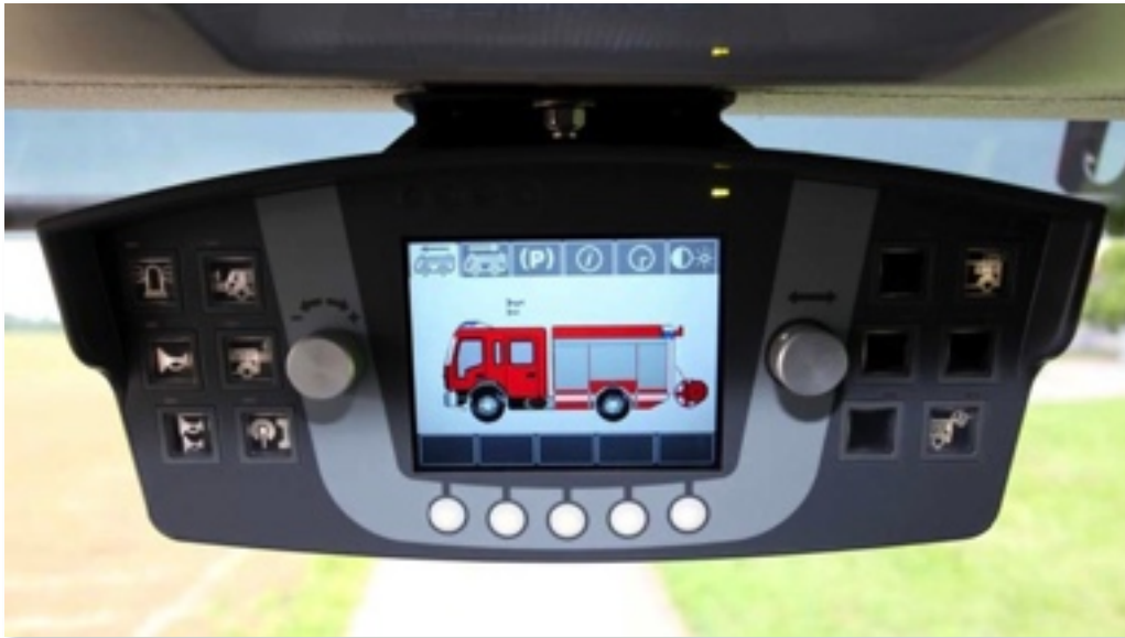
Control HMI en cabina
