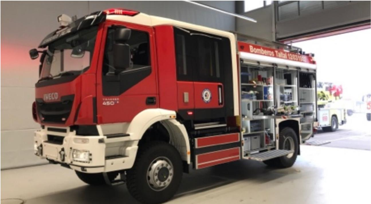
8.1 Estructura Principal: Carrocería completamente en perfiles de aluminio extruido y anodizado reforzado ensamblado por piezas de unión, mantenida por visaje, y paneles de aluminio pegados:
