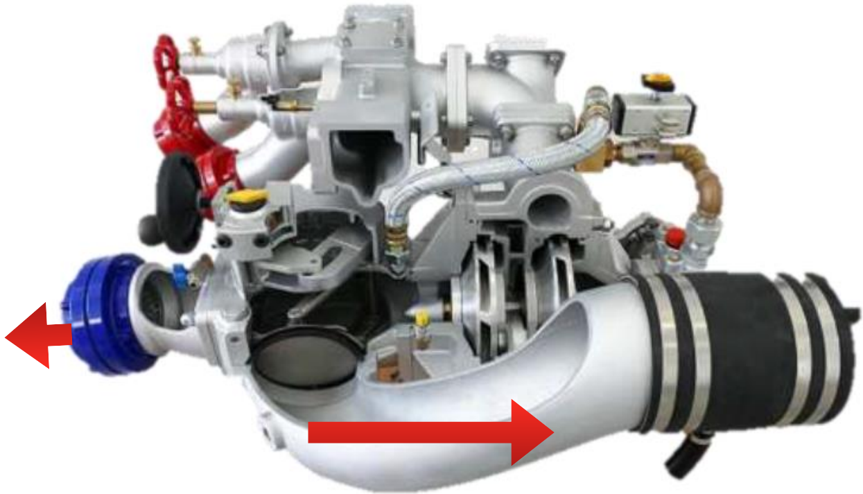
Flujo del exceso de presión.
