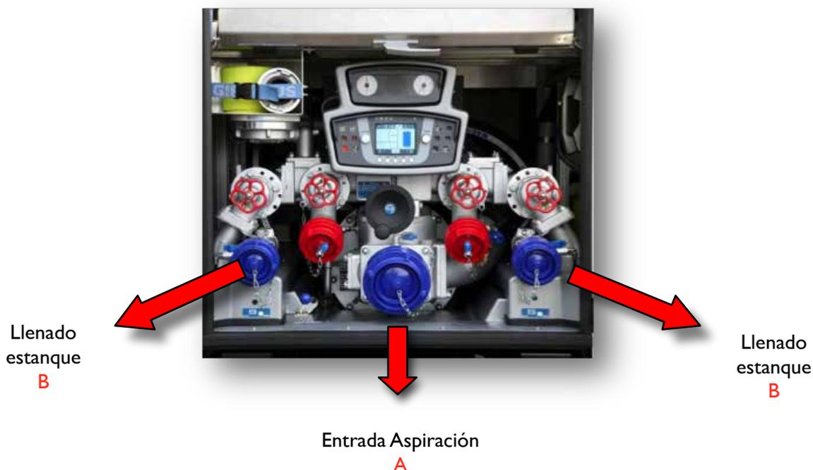
**10.13 - 10.14- 10.15 Sistema de regulación y estabilización de presión de descarga**
