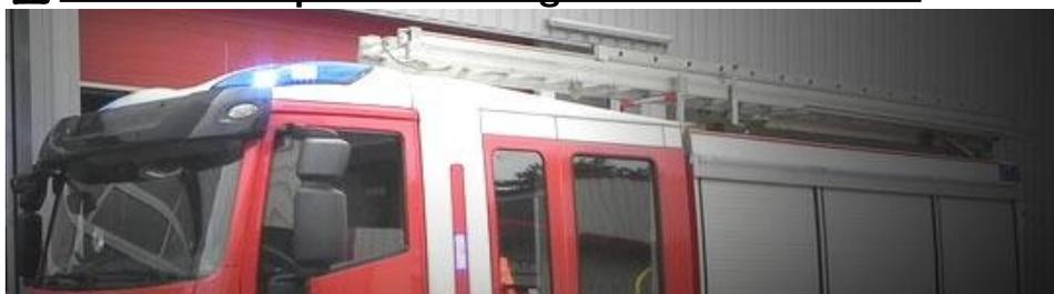
Baliza integrada sobre el techo de la unidad, de esta manera se obtiene una unidad mas aerodinámica y moderna. Las balizas son LED y están completamente integradas al sistema CanBUS de la unidad.
