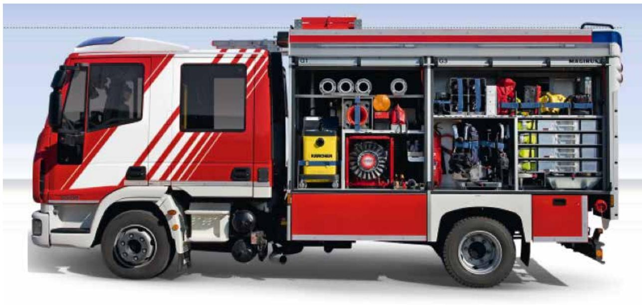
8.1 Estructura Principal: Carrocería completamente en perfiles de aluminio reforzado ensamblado por piezas de unión, mantenida por visaje, y paneles de aluminio pegados:
